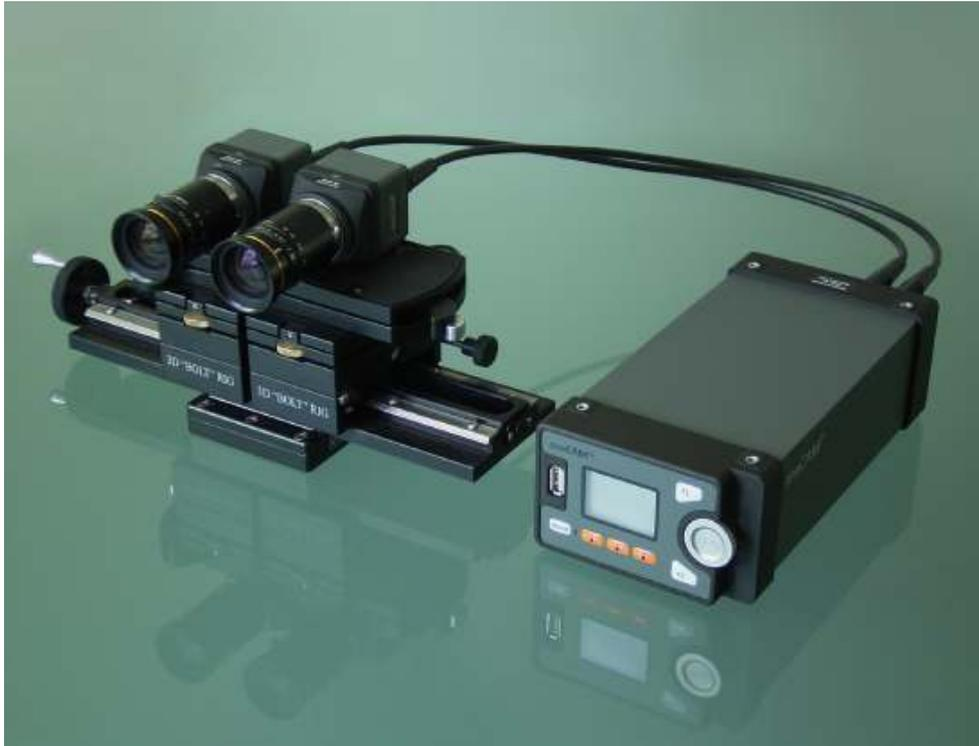
Die „proCAM“-Plattform ist ein neuartiges "Real 3D"-HD-Kamerasystem mit abgesetzten Kameraköpfen mit geräteinterner Bildverarbeitung und Synchronisation. Sie dient als Basis für branchenspezifische Varianten wie "sinaCAM" im professionellen Filmbereich oder "medCAM" im Medizinbereich. Abgesetzte Kameraköpfe (bis zu 200 m!)
