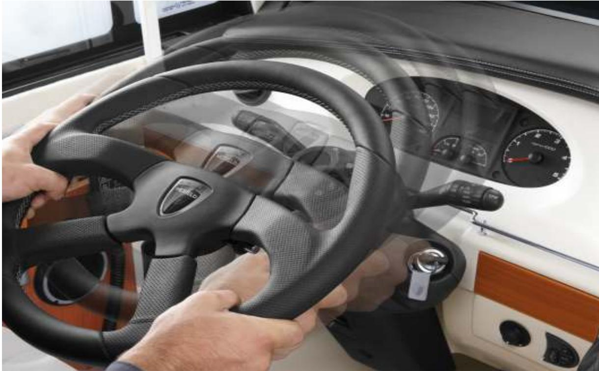
Bei den Rennboliden im Motorsport ist es nicht mehr wegzudenken: das abnehmbare Lenkrad. Morelo nutzt exakt diese Technik für ihr abnehmbares Lederlenkrad für integrierte Reisemobile. Nach dem Entfernen kann der Fahrersitz problemlos und ohne jedes Hindernis um 180 Grad ins Wageninnere gedreht werden. Das abnehmbare Lenkrad erzeugt eine enorme Raumgewinnung im Wohnbereich bei integrierten Wohnmobilen - nur durch ein paar einfache Handgriffe.
