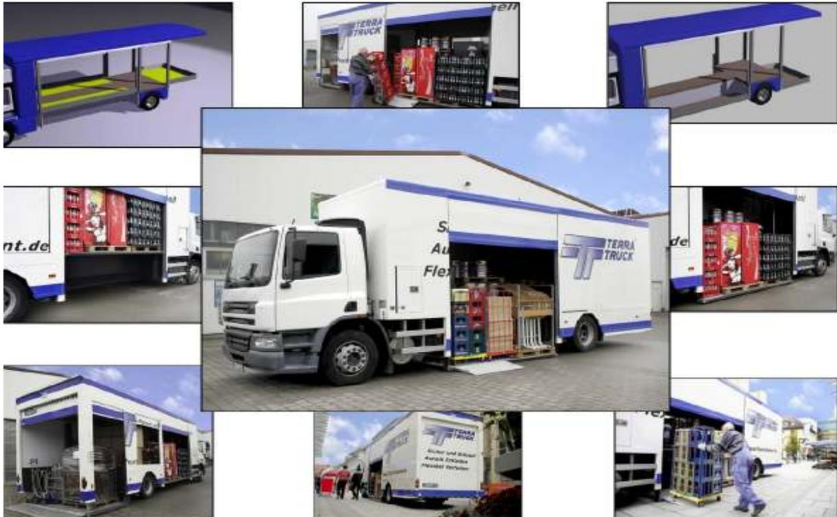
Der TERRA-TRUCK ist ein in Augsburg entwickelter Verteiler-LKW mit innenliegenden partiell absenkbareren Transportflächen. Diese Flächen sind stufenlos absenkbar und ermöglichen einen ebenerdigen Zugang. Mit dem Absenken von Teilen der Ladefläche nimmt der TERRA-TRUCK von drei Seiten die Fracht auf und bietet mehrseitigen Zugang zur Ware. Selbst das herkömmliche Durchladen wie auch die Beladung über eine Laderampe sind möglich.
