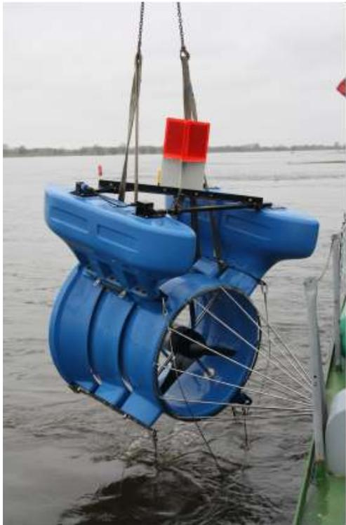
Ein mobiles 5 kW Kleinst-Wasserkraftwerk, das ausschließlich mit der kinetischen Energie des Wassers arbeitet und keinerlei Aufstauung benötigt.
