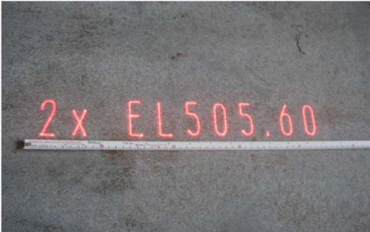
LasKom-Laserdisplay (kurz: LasKom®) ist ein Anzeigesystem, welches für die an einem Kommissionier- oder Montageplatz benötigten Teile die Informationen mit Hilfe eines Laserprojektors visualisiert. Je nach Einsatzgebiet können dabei auch gleichzeitig mehrere Projektoren verwendet werden.
