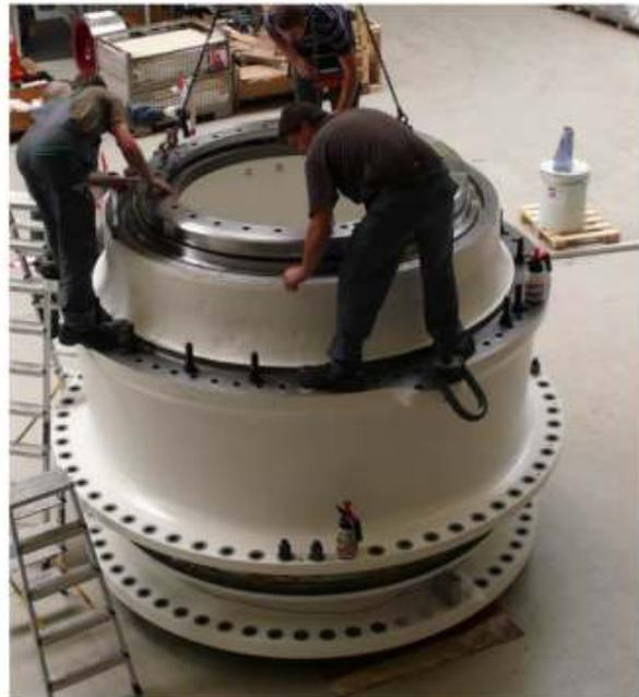
EOLOTEC bietet mit der eigens entwickelten Hauptlagerung (MBU Main Bearing Unit) einen völlig neuen Lösungsansatz für die Wälzlagerung von Rotoren für Windkraftanlagen (WKA) über einer Leistung von 2 MW. Der kompakte Baugruppencharakter der MBU ermöglicht eine kostengünstige und sichere Montage bei der Windturbinenerrichtung. Durch das komplett abgedichtete und voreingestellte Konzept besteht keinerlei Gefahr einer Verunreinigung der Wälzlager oder fehlerhaftem Zusammenbau.
