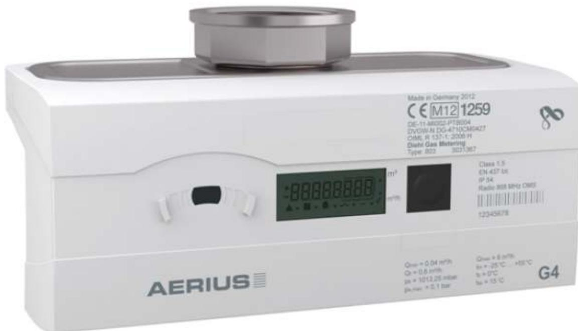
Der innovative neue Gaszählertyp ist mit einem mikrothermischen Sensor ausgestattet, wurde Ende 2011 bei der PTB (Physikalische Technische Bundesanstalt) zugelassen, und kann direkt das Normvolumen der verbrauchten Gasmenge bestimmen. Die heute etablierten Umrechnungsalgorithmen in den Abrechnungssystemen der Versorger sind damit überflüssig, Endverbraucher erhalten mehr Transparenz auf Ihrer Energierechnung, das Image von Energieversorgern wird damit kundenfreundlicher.
