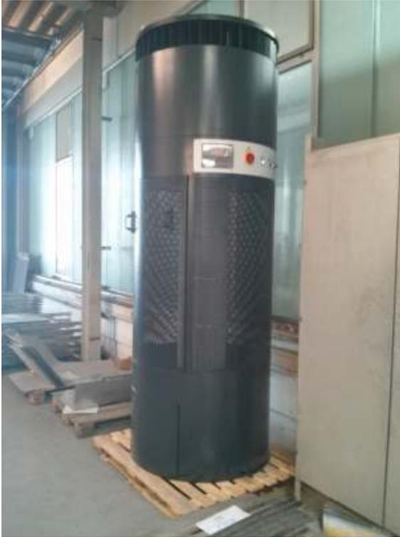
Stationäre Absaugung und Filtrierung von trockenen Schleifstäuben.
