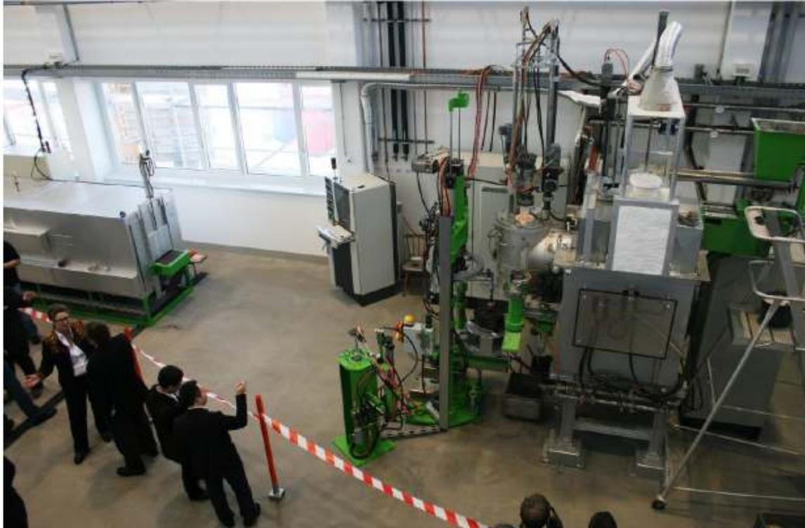
Der Mini-Melter ist ein Aggregat zum elektrischen Schmelzen und Ausarbeiten von Glas mit hohen Qualitätsanforderungen aber kleinen Tagesdurchsätzen von 100 kg bis 2.000 kg pro Tag. Diese Anforderung wird im Bereich von Spezialgläsern, optischen Komponenten und Design- und Luxusgläsern mit limitierten Auflagen nachgefragt. Um in diesem Segment wirtschaftlich fertigen zu können, bedarf es einer anspruchsvollen, integrierten technischen Lösung.
