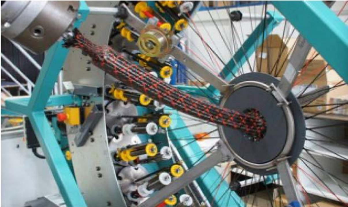
Munich Composites hat verschiedene Konzepte entwickelt und patentiert, mit denen die Fertigung von Faserverbund-Leichtbaustrukturen automatisiert werden kann. Basis ist die Flechttechnologie, die in Kombination mit Harzinjektionsverfahren die kostengünstige Fertigung von Profilen und Hohlbauteilen für den Automobilbau, den Flugzeugbau oder die Sportartikelindustrie ermöglicht.
