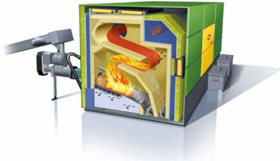
Der Power-Würfel HDG M300-400 ist eine von der HDG Bavaria GmbH neu entwickelte Hackgut- und Pelletfeuerung für eine energieeffiziente und klimaschonende Wärmeerzeugung.
