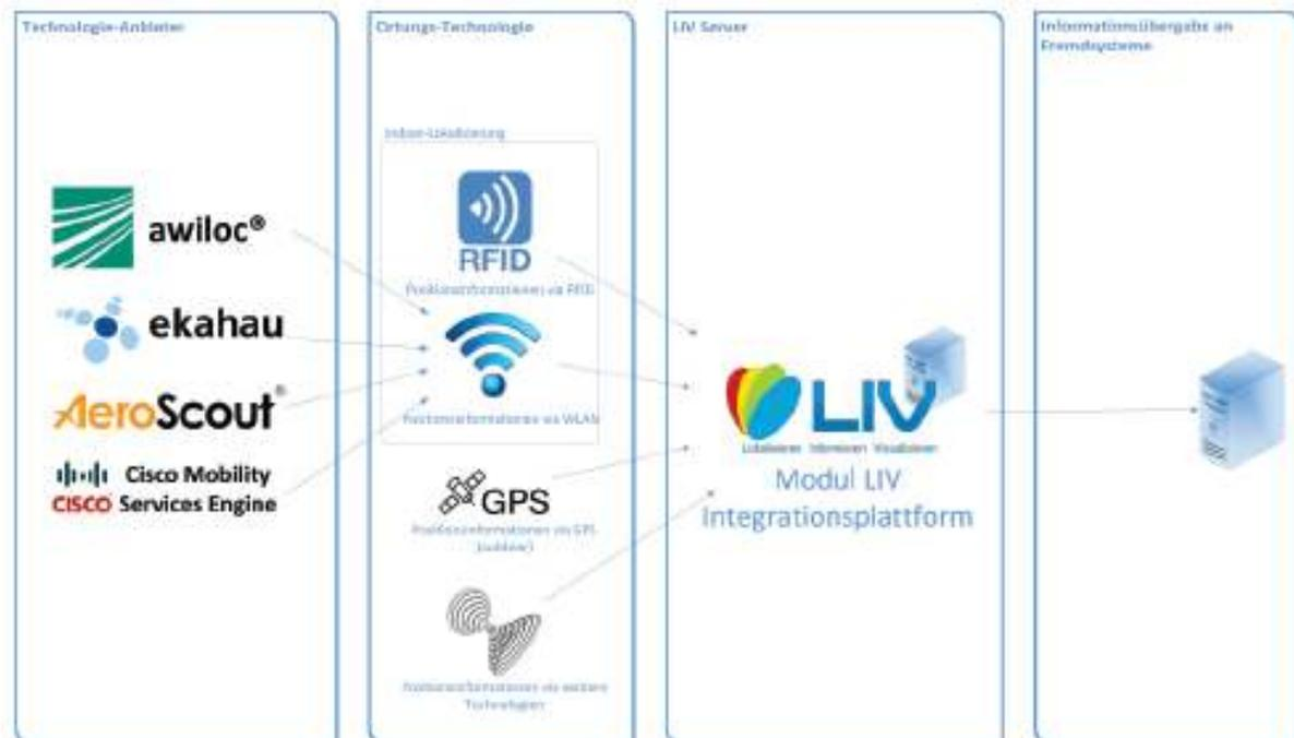
Die LIV Integrationsplattform ist eine serverbasierte Lösung, die Informationen von verschiedenen Positionstechnologien, wie beispielsweise GPS, RFID oder WLAN aufnimmt, verarbeitet und bewertet und dann durch eine individuell konfigurierbare Schnittstelle an ein Fremdsystem übermittelt.
