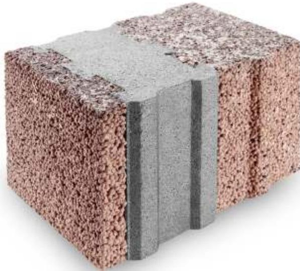
Der Liapor NeoStone® ist der erste Planstein mit durchgehend geschützter Dämmschicht aus EPS-Hartschaumstoff. Schallschutz und Wärmeschutz sind damit automatisch in den Stein integriert. Das gleiche gilt für den mechanischen Schutz der Dämmung - etwa gegen Stöße - für den die Außenschicht mit Liapor-Blähton sorgt.
