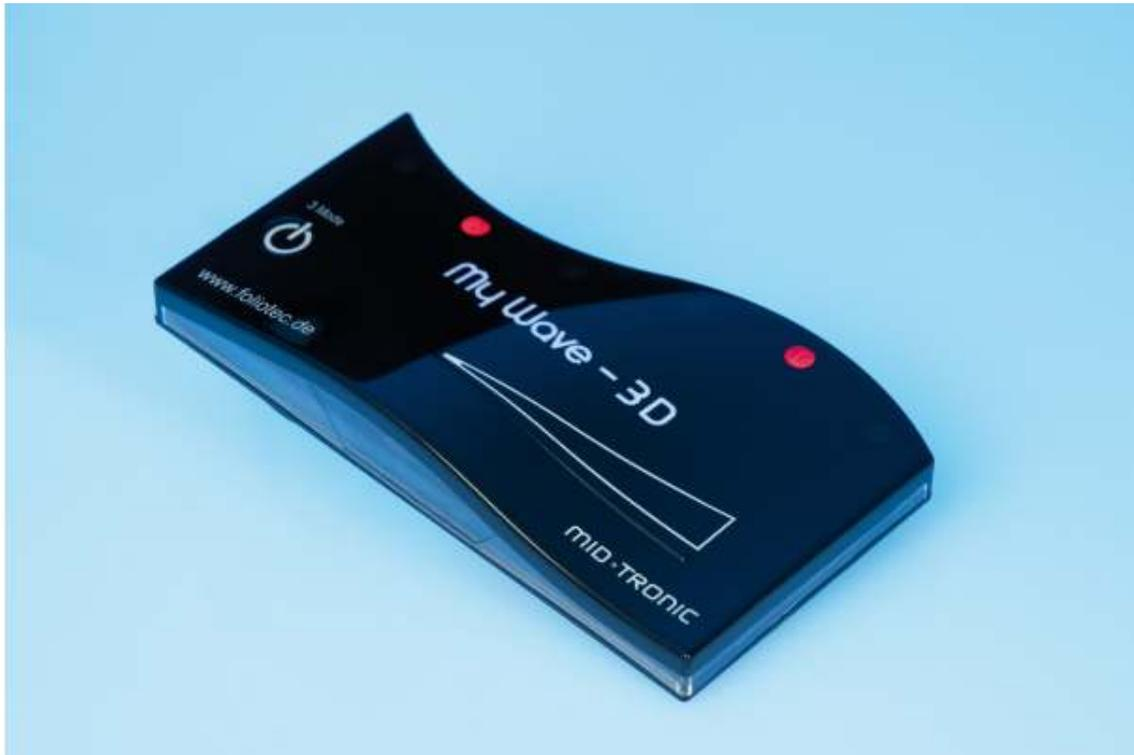
Die MyWave 3D ist eine gelungene Integration zweier High-End-Kunststofftechnologien (IML und LDS-MID) in einen ansprechenden Demonstrator, der dem Trend zur tastenlosen Bedienung gerecht wird und diese auf einer 3D Oberfläche ermöglicht.
