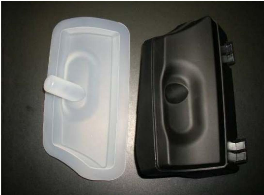
Der PUReLiner ist ein semi-permanenter Werkzeuginliner (Einleger) aus einem selbsttrennenden Kunststoff-Compound.
