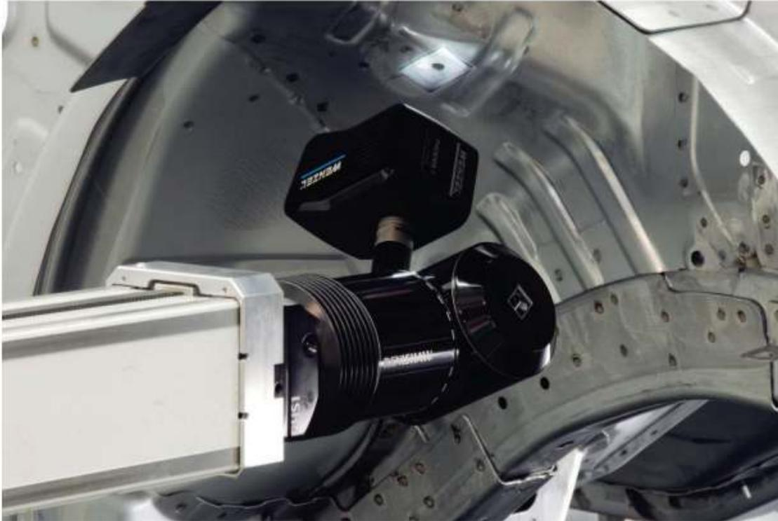
WENZEL hat mit dem neuen PHOENIX Pionierarbeit im Bereich der optischen Messtechnik geleistet. In nur einem Arbeitsgang erfasst der neue optische 3D Sensor schnell und berührungsfrei sowohl Geometrielemente als auch Flächen unterschiedlicher Materialien.
