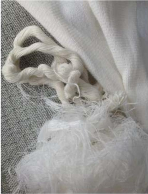
Nachhaltigkeit bei Hochleistungsfasern - Sinnvolles Recycling vom "Abfall" eines Hochleistungsgewebes zum erneuten Hochleistungsgarn.
