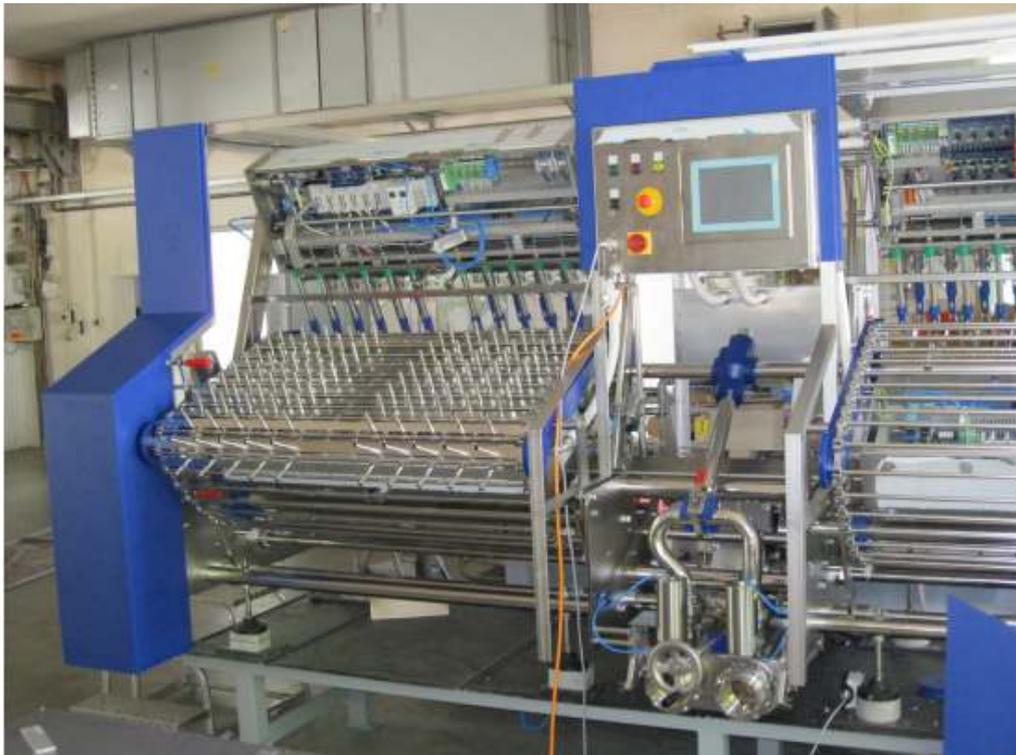
Multifüllmaschine KM 20/12 zum halbautomatischen Befüllen von Früchten mit Frischkäse, wie z.B. Peperoni, Teufli, Pepperballs, Oliven. Komplett aus V4A-Edelstahl bzw. Kunststoffen. Sämtliche Materialien, die mit den Produkten in Berührung kommen, sind lebensmittelzugelassen.
