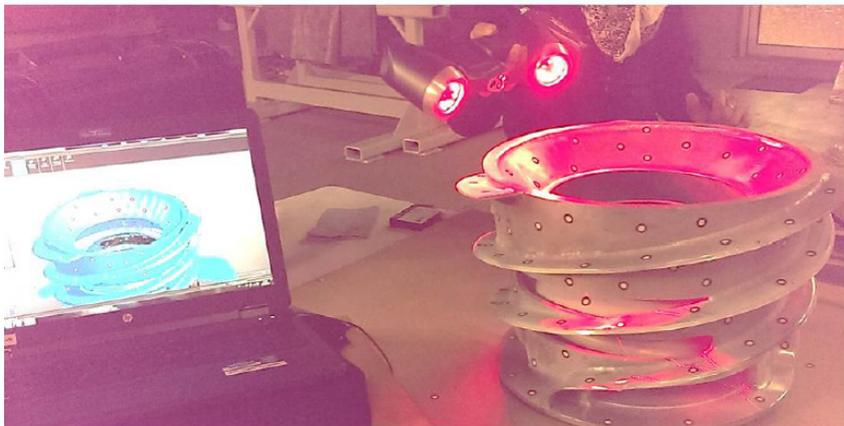
**SFM hat den Vor Ort Einsatz des 3dLaserScan-Verfahrens zum Aufmessen von komplexen Komponenten mit teilverdeckten Oberflächen entwickelt und auf die besonderen Anforderungen der Verfahrenstechnik adaptiert**
